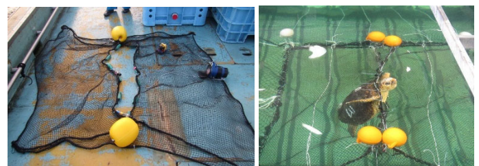
試作したウミガメ脱出装置の概要とウミガメが脱出する様子
