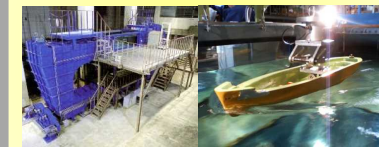
⑬垂直循環型回流水槽
